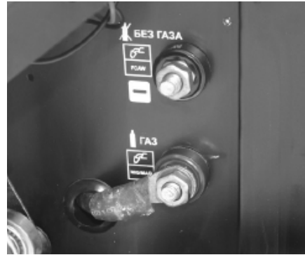
Рис. 9 Клеммы подключения кабеля механизма подачи проволоки
